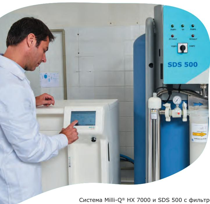
Система Milli-Q® HX 7000 и SDS 500 с фильтром Opticap® XLT20 Durapore® 0.22 мкм и УФ-лампой в петле рециркуляции.
