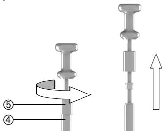
2. Отвинтите всасывающий наконечник ③ и вытащите из трубки поршень ⑥.
