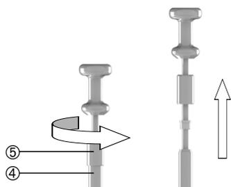
2. Desenrosque el cabezal de succión ③ y retire el pistón ⑥ del tubo.
